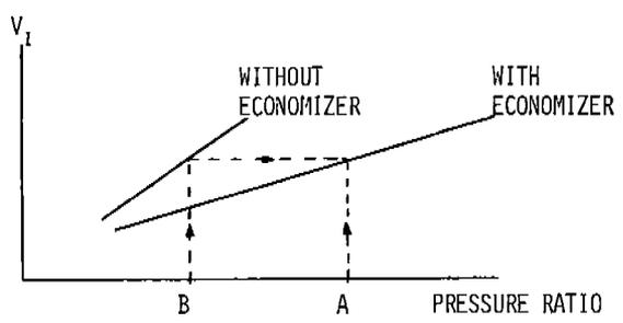
FIG. 4: PRINCIPLE OF  $V_1$ -CORRECTION FOR ECONOMIZER OPERATION
