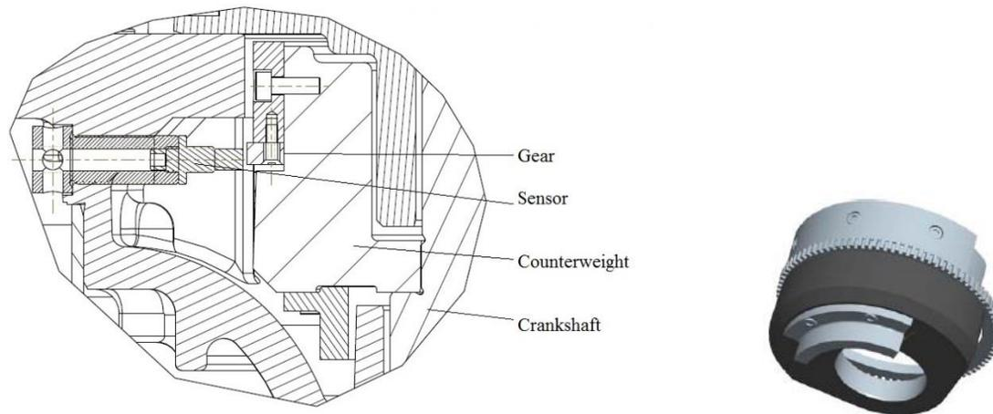
**Figure 2:** Gear coder
