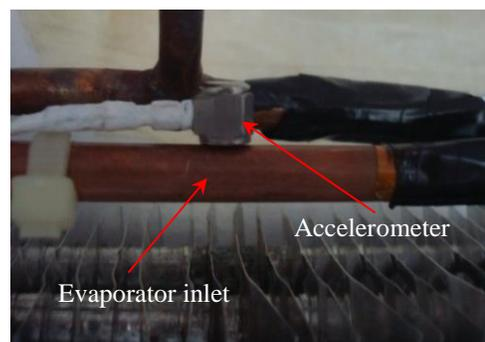
**Figure 4:** Accelerometer
