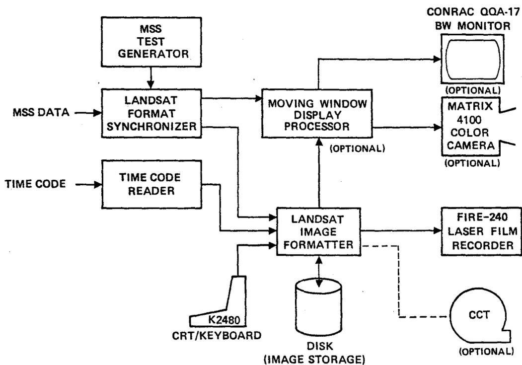
FIGURE 3. ALASKAN LANDSAT QUICKLOOK SYSTEM BLOCK DIAGRAM
