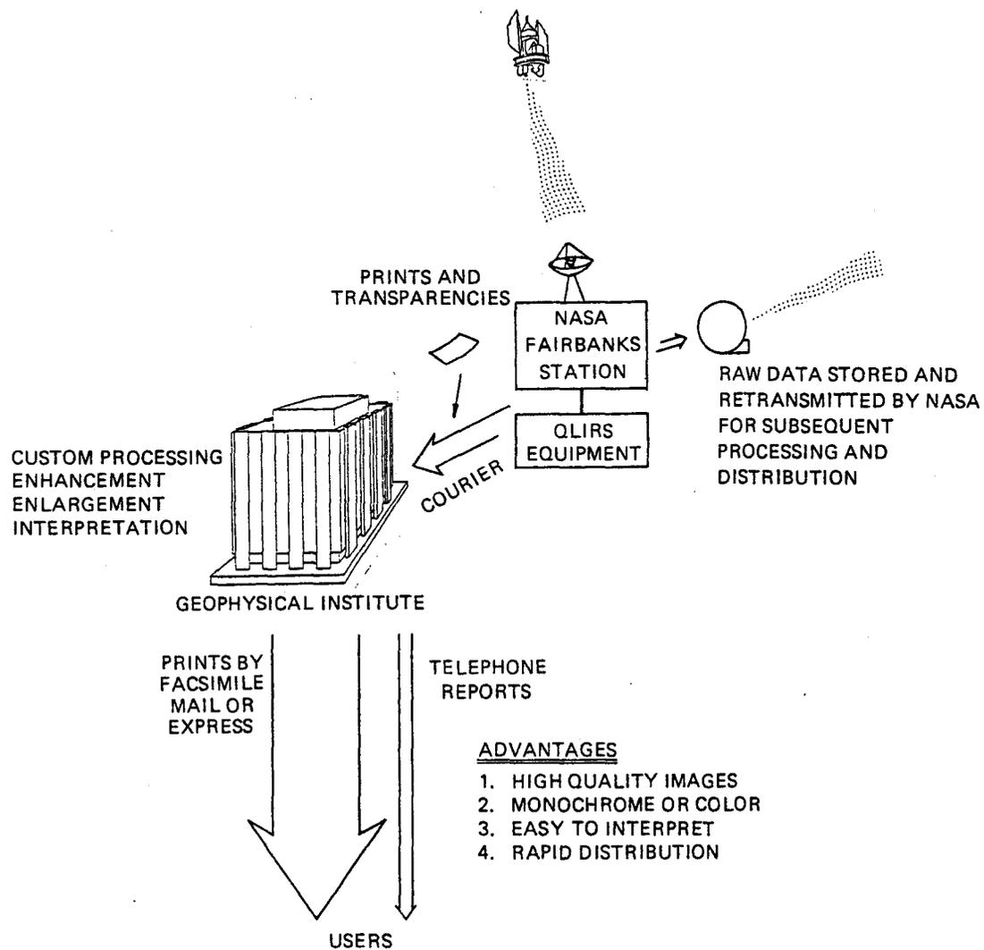
FIGURE 1. ALASKAN LANDSAT QUICK-LOOK IMAGE RECORDING SYSTEM (QLIRS)
