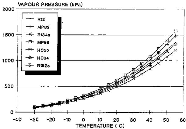
Fig 1 VAPOUR PRESSURES POTENTIAL REFRIGERANTS
