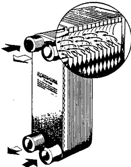
FIG 2 BRAZED PLATE HEAT EXCHANGER
