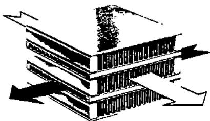
FIG 4 PLATE-FIN HEAT EXCHANGER (CROSSFLOW TYPE)
