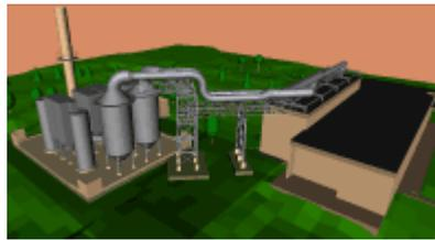
FIGURE 1 VRML WORLD OF THE NIST FIRE RESEARCH FACILITY EMISSIONS CONTROL SYSTEM
