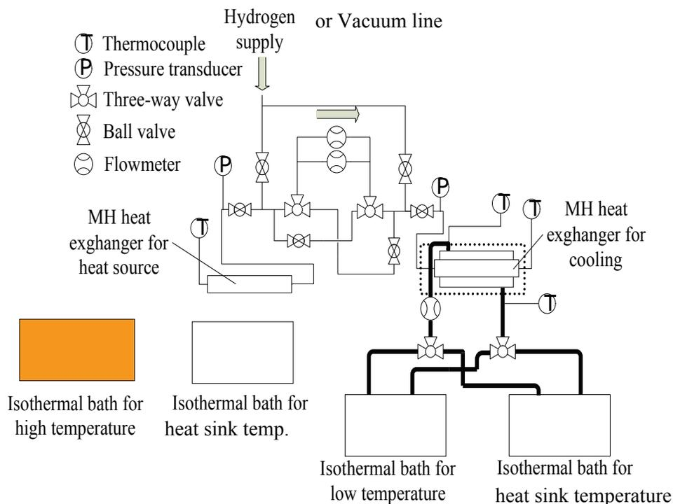
Figure 2 : Experimental apparatus
