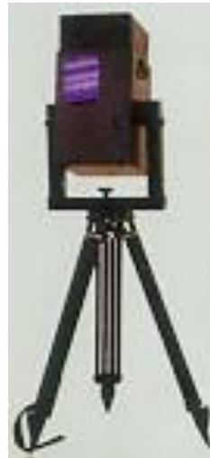
FIGURE 1 CYRAX LASER SCANNER
